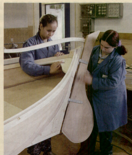
De boot is bijna klaar, nu nog de lijmvlakken wegschuren.
