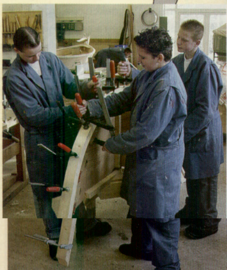
Leerlingen starten met de bouw van een tweede schoolboot: het lamineren van de voorsteven.
