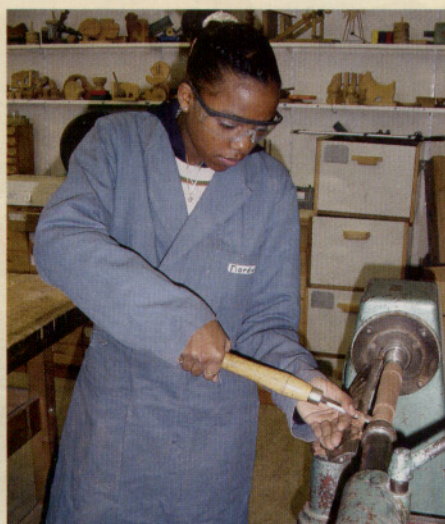
Het draaien van de korvijngagels: maatwerk!
